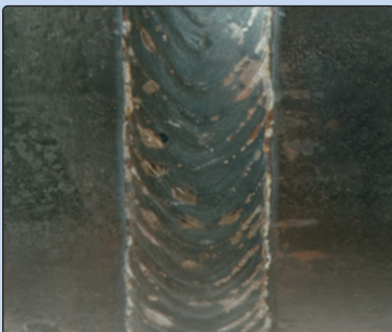
Acero carbono con MIG pulsada
